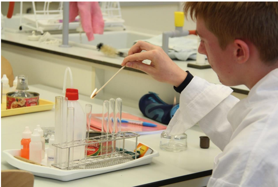
hidrogén kimutatása durranógázpróbával
